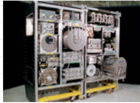
Het waterzuiveringssysteem in het Internationale Ruimtestation ISS zuivert ook de urine van astronauten. Dat kan dan weer gebruikt worden als drinkwater
